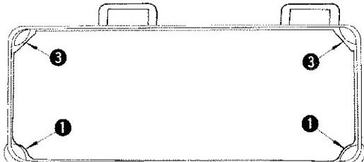
2. Закрепите две резиновые опоры (1) на стороне А (сторона оператора) при помощи гвоздей (2), как показано на рисунке. Закрепите две упругие опоры (3) на стороне (В) (где петли) при помощи резинового клея. Затем поместите нижнюю крышку на закрепленные резиновые опоры (1).
