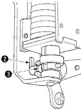
Удалите крышку отсекателя нити (1) и нанесите смазочную жидкость на отверстие соленоидной основы отсекателя (2) и соединительное кольцо (3).
