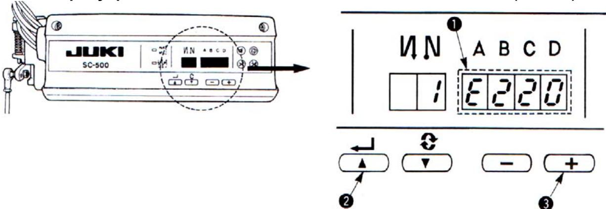
После определенного времени эксплуатации машины на дисплее блока управления при его включении появится код ошибки error code №220, и раздадутся 5 прерывающихся предупреждающих гудящих сигналов. Это означает, что пришло время смазать определенные части машины (см. пункт 4-5). Для прекращения предупреждающего сигнала нажмите одновременно клавиши ↑ (2) и + (3), включите питание машины.
