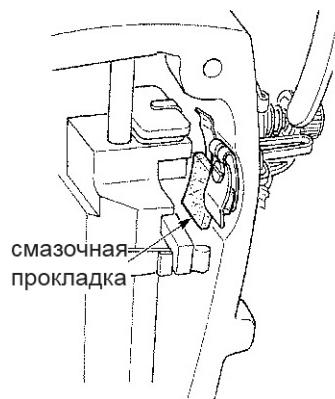
**Общие рекомендации:** удалите резиновую заглушку, снимите прокладку (A), налейте смазочную жидкость в отверстие. Затем очистите прокладку и отверстие от старой смазки, поместите прокладку на место, нанесите смазочную жидкость на прокладку и закройте её резиновой заглушкой.
