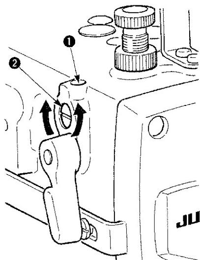
Ослабьте винт (1), поверните болт микрофильтра (2). Затем можете регулировать высоту прижимной лапки в диапазоне от 0 до 0,5мм.
